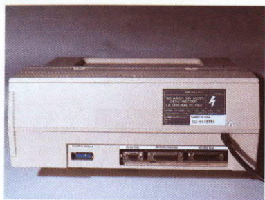
Parte trasera de la CPU, con los switches de selección del modo de vídeo a la izquierda
